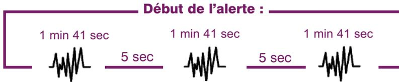
La sirène émet un signal modulé montant et descendant d'une minute et 41 secondes. Ce signal est répété trois fois avec 5 secondes d'intervalle.
